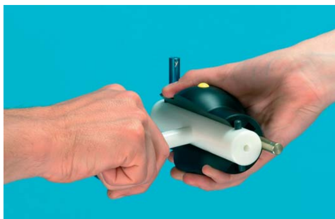
▲ Figure 1. Un exemple de liaison pivot
